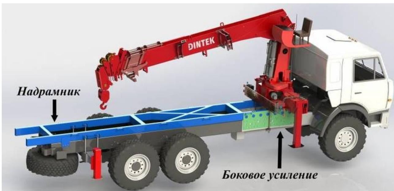
Если КМУ не имеет откидных лап, то впоследствии баки, АКБ, ресиверы и ящики придется переносить на новые места. КМУ европейских производителей, как правило, имеют откидные лапы и не требуют переноса многих элементов. Если задние крылья крепятся непосредственно к бортовой
